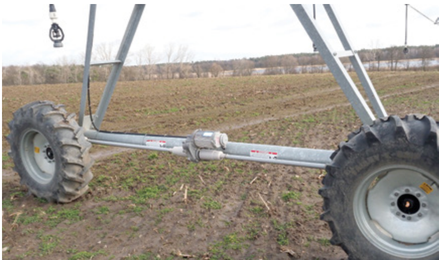
Koła podpór stalowej konstrukcji napędzane są za pomocą silnika elektrycznego
