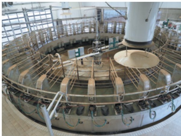
Na fermie w Czachu krowy dojne są obecnie w zewnętrznej dojarni karuzelowej mieszczącej 40 stanowisk udojowych
