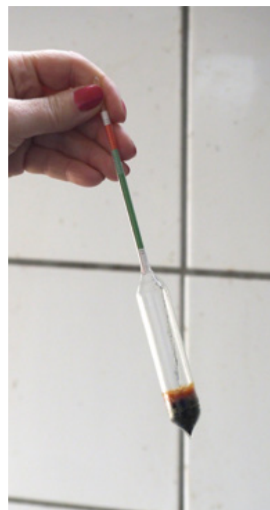
Prostym sposobem pomiaru jakości siary jest zastosowanie siaromierza
