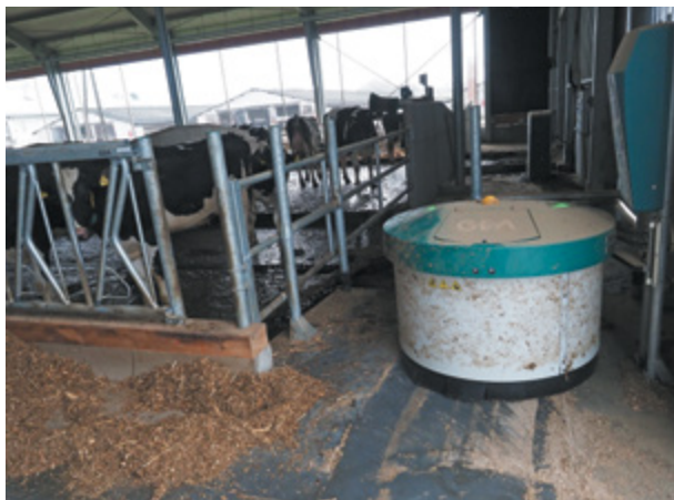
Robot FRone do podgarniania pasz podczas ładowania akumulatorów w stacji ładowania
