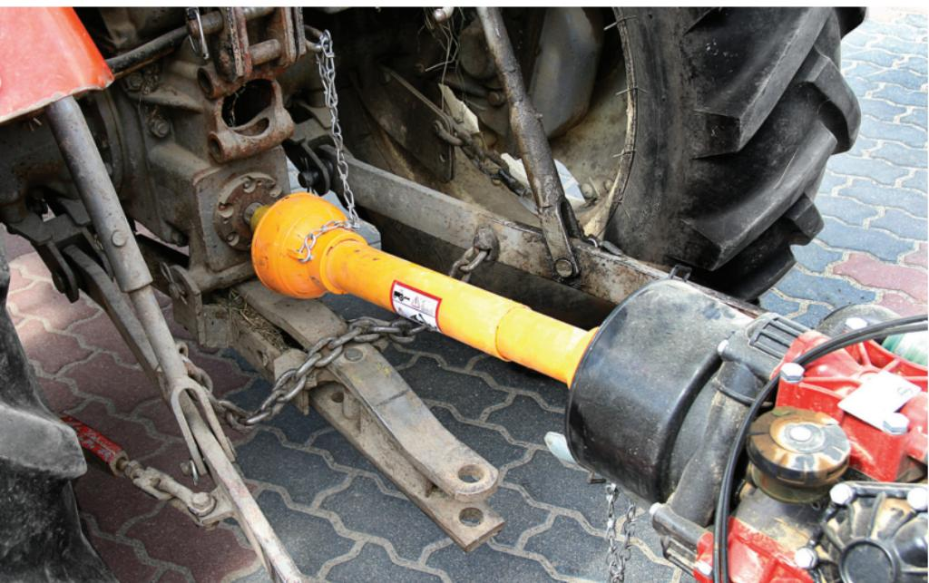
**Łańcuszki osłony należy przyczepić do nieruchomej części ciągnika i nieruchomej części maszyny. Nigdy nie rozpoczynaj pracy bez osłony lub z osłoną uszkodzoną. Pochwycenie przez obracający się wałek jest przyczyną wielu śmiertelnych wypadków!**
