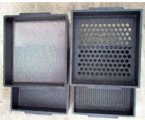
Fot. 2. Sita „pensylwańskie” do oceny stopnia rozdrobnienia zakiszonego materiału.
